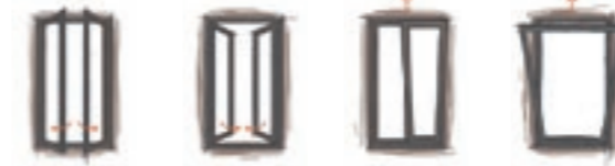
à la française à l'anglaise en oscillo-battant à soufflet
